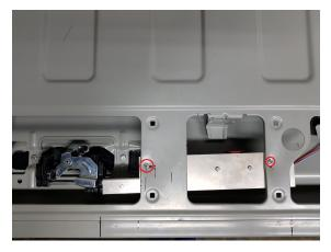
**6)** Installez la plaque de base et le kit d'actionneur, en utilisant les vis M6 fournies
