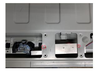
7) Connectez le faisceau de câbles à l'actionneur:
