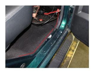
**11)** Soudez le faisceau de câblage dans les circuits électriques du véhicule. Vous pouvez utiliser les verrous scotch fournis mais la soudure est recommandée.
