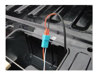
**8)** Faites passer le câble par le hayon et sous la carrosserie du véhicule. Faites passer le câble jusqu'à la zone de la porte avant du conducteur
