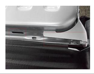
**9)** Retirez le seuil de porte en plastique du côté du conducteur pour localiser le faisceau de câbles du véhicule
