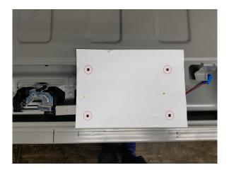
**5)** Percez soigneusement des trous de 6mm et mettez la plaque de base et le kit d'actionneur en position
